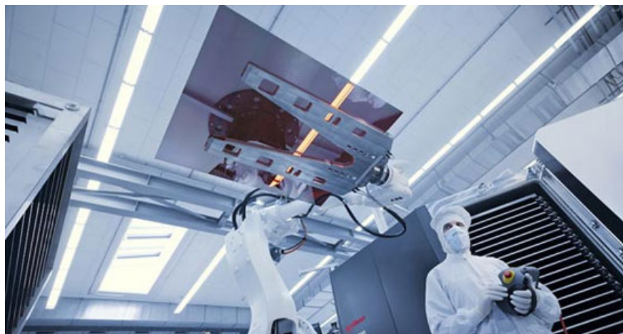
Sensibles Gut: Nach der Halbleiterbeschichtung werden Dünnschichtmodule behutsam zwischengelagert. Foto: Oerlikon Solar
