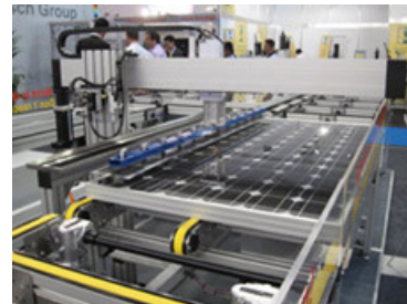
Automatisierungstechnik gewinnt in der Solarindustrie zunehmend an Bedeutung. Links: Roboter zur Solarzellenproduktion. Rechts: Rexroth-Transfersystem TSsolar befördert hochempfindliche Photovoltaikmodule sicher und sauber. Bildquellen: Solar Promotion GmbH; Quelle: Solarserver.
