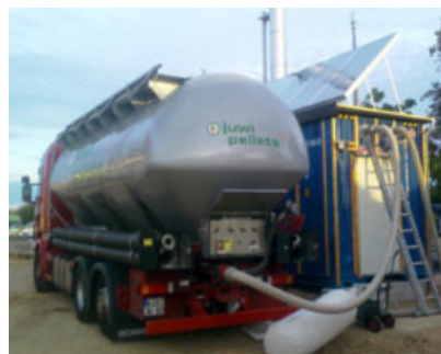
Die Energiekabine liefert Wärme aus Solarthermie-Kollektoren, Holzpellets und Holz hackschnitzeln. Rechts: Holzpellet-Lieferung
