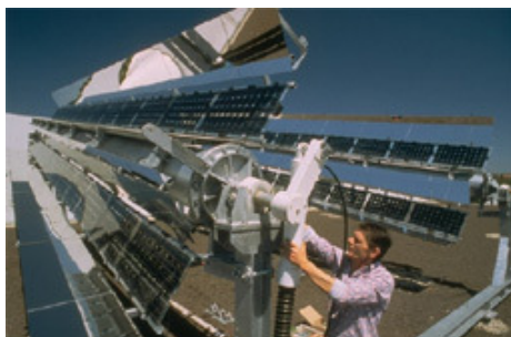
Thermohydraulische Nachführung in Stuttgart Bad Cannstatt; Funktionsprinzip. Foto und Grafik: ARCHIMEDES Solar GmbH
