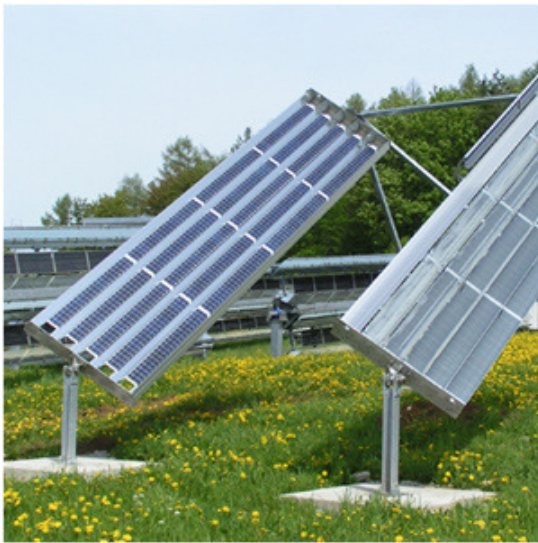
Foto: ARCHIMEDES IVT (links) mit schwacher (zweifacher) Konzentration und ARCHIMEDES IPT (rechts) im Testfeld "Widderstall".
