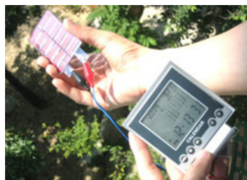
Am Fraunhofer ISE hergestellte, flexible Organische Solarzelle. Organische Solarzelle der Universität von Kalifornien in Santa Barbara (UCSB). Quellen: ISE; UCSB
