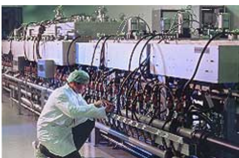
Photovoltaik-Fortschritt: Links die CIS-Pilotfertigungslinie von Würth Solar im Jahr 2000 (jährlicher Output rund 1 Megawatt), rechts die 2007 eröffnete CISfab (Produktionskapazität im Jahr 2008: 30 Megawatt). Bildquelle: Würth Solar
